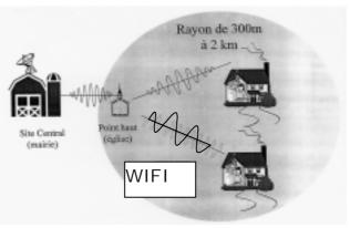
avec les ordinateurs des usagers en utilisant une liaison par ondes radio (dite WIFI); dès lors qu'un nombre suffisant d'usagers est atteint (quelques dizaines) le coût de connexion devient abordable (comparable à un abonnement A.D.S.L.).
